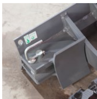
Dozerblad handmatig te verbreden
